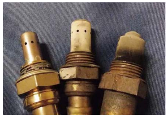
新的氧气传感器（左）和结垢的氧气传感器（中间和右边）。二氧化硅形成的白色沉积物正如中间的传感器所示。
